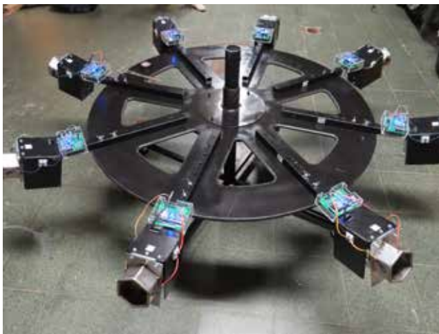
De SnuffelSensor, een carousel die de exacte duur meet waarmee de honden aan hun doelen snuffelen. De snuffelduur kan iets zeggen over de accuraatheid van de hond en de emotionele lading van de geur. (© Hilde Vervaecke)
