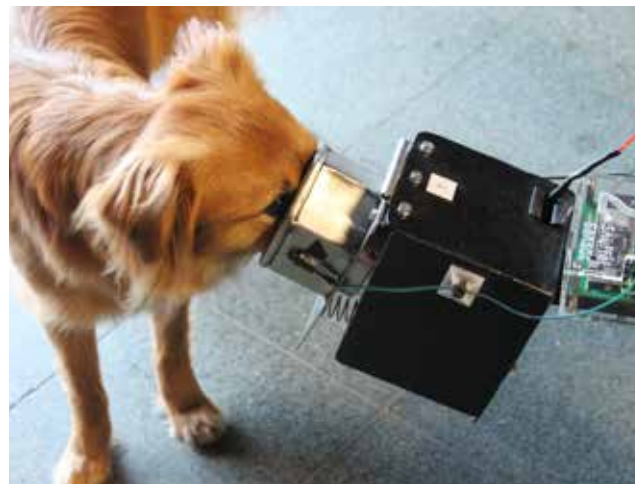
De SnuffelSensor, een carousel die de exacte duur meet waarmee de honden aan hun doelen snuffelen. De snuffelduur kan iets zeggen over de accuraatheid van de hond en de emotionele lading van de geur. (© Hilde Vervaecke)
